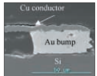
Kuva 6. Juotteeton liitos kultanystyyn. Figure 6. Solderless interconnection to gold bump.
