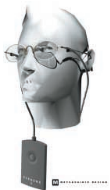
Konsepti CyPhonen lisälaitteesta, jolla voidaan siirtää tietoa langattomasti puhelimesta silmikkonäyttöön. A concept of a CyPhone accessory that enables wireless information transfer from the terminal to the head mounted display.
