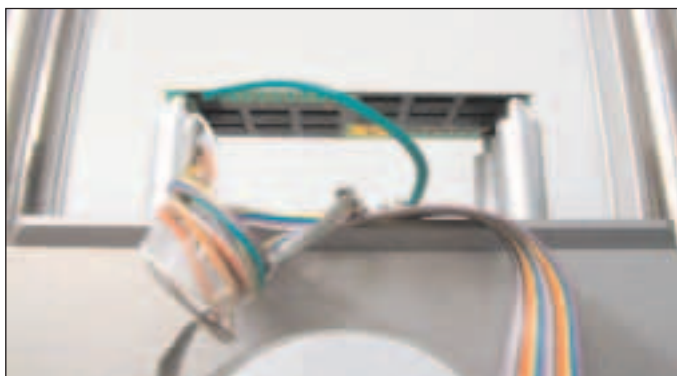
Piirilevyn kiinnitys Nokian kehittämään pudotustestilaitteeseen.
