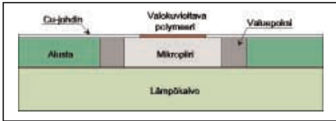
Kuva 5. (a) Lämpömallinnuksessa käytetyn rakenteen poikkileikkaus. Figure 5. (a) A schematic presentation of the structure used in the thermal modeling.
