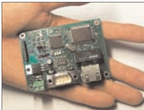
Upponetin Ethernet-kortti, joka mahdollistaa sarjaporttiin kytkettävän tuotteen liittämisen Internetiin. Kortti toteuttaa protokollat ARP, IP, ICMP, UDP, TCP, HTTP, DHCP ja sähköposti. Kortilla on I/O-lähtöjä ja vapaata prosessointitehoa myös käyttäjän sovelluksille.
