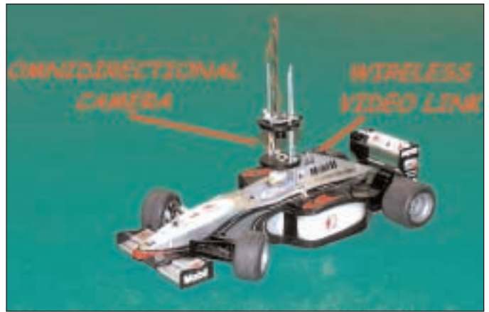
Radio-ohjattavan auton avulla on tutkittu lisätyn todellisuuden soveltuvuutta etäoperointiin. A radio-controlled car has been utilised in research of teleoperation via augmented reality.
