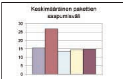
Pakettien saapumisväli ja viivevaihtelu eri protokollilla. Mittauksissa lähetystaajuus oli 200 pakettia sekunnissa ja koko 192 tavua. The latency and intervall with different protocols. The transmission frequency was 200 packets per second and packet size was 192 bytes.
